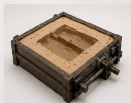
MOULAGE AU SABLE Moule prêt pour la coulée.
