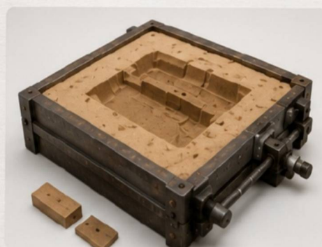
MOULAGE AU SABLE Préparation du moule en sable.
